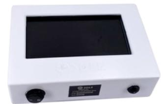
Se puede proporcionar un monitor adicional para el Puesto de Tirador eliminando la necesidad de hacer puntería por el antiguo ocular óptico. Opcionalmente se puede instalar un monitor para el Puesto de Jefe de Carro.
